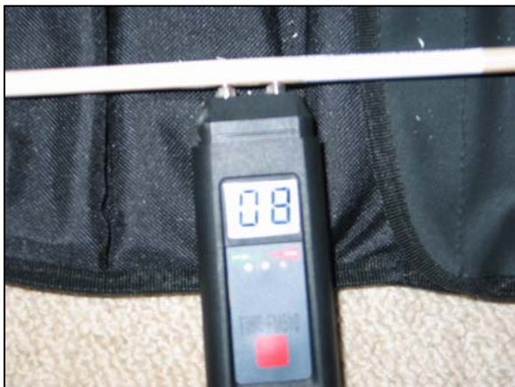
Fugt i dyvel før montering. Fugtighed 8%
